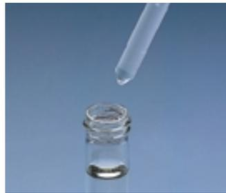
Incluso medios de alta presión de vapor hasta 500 mbar, como alcoholes, éteres e hidrocarburos, se pueden dosificar con máxima precisión de manera simple y fiable.
