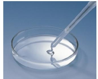
El Transferpettor es el aparato ideal para pipetear medios de alta viscosidad, como soluciones proteínicas muy concentradas, aceites, resinas y grasas, hasta una viscosidad de 50.000 mm<sup>2</sup>/s. Medios de alta densidad hasta 13,6 g/cm<sup>3</sup>, como glicerina, mercurio, ácido sulfúrico, etc., se pueden dosificar sin cambiar el calibrado.
