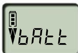
Para prolongar la vida útil y aumentar la potencia de las baterías, Transferpette® electronic dispone de una función de regeneración (la función Refresh); es la primera micropipeta que la incluye. La batería está programada para, en caso necesario, descargarse completamente para después cargarse de nuevo.
